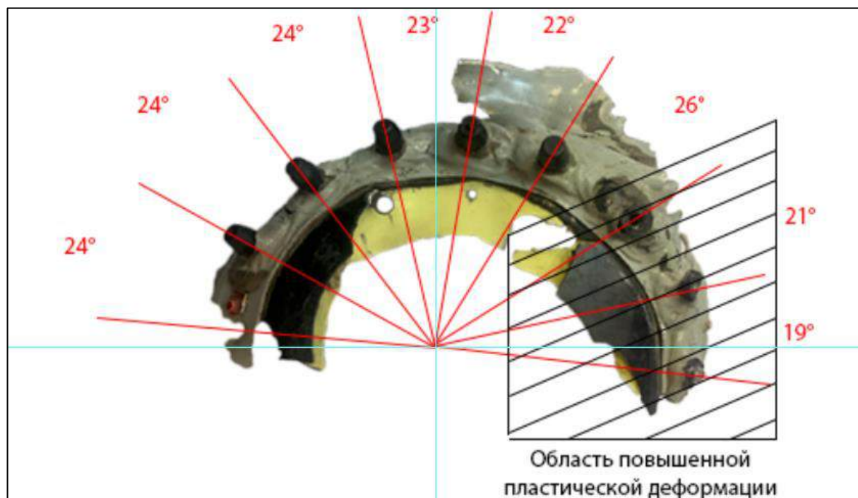
Рис. 122. Пластическая деформация исследуемого фрагмента
