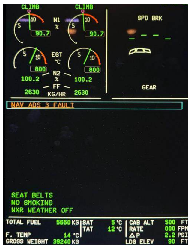
Рис. 144. Имитация индикации CAS-сообщения «NAV ADS 3 FAULT» на EWD тренажера
