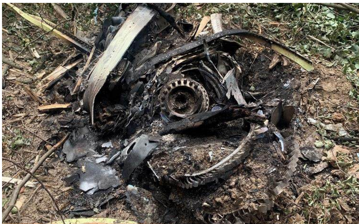
Рис. 32. Фрагменты правого двигателя на месте АП
