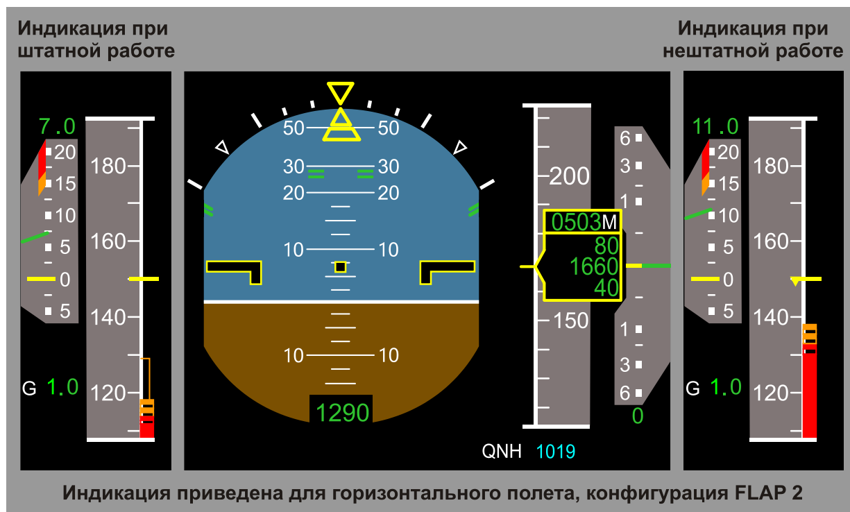
Рис. 78. Косвенный признак ошибочных показаний углов атаки
