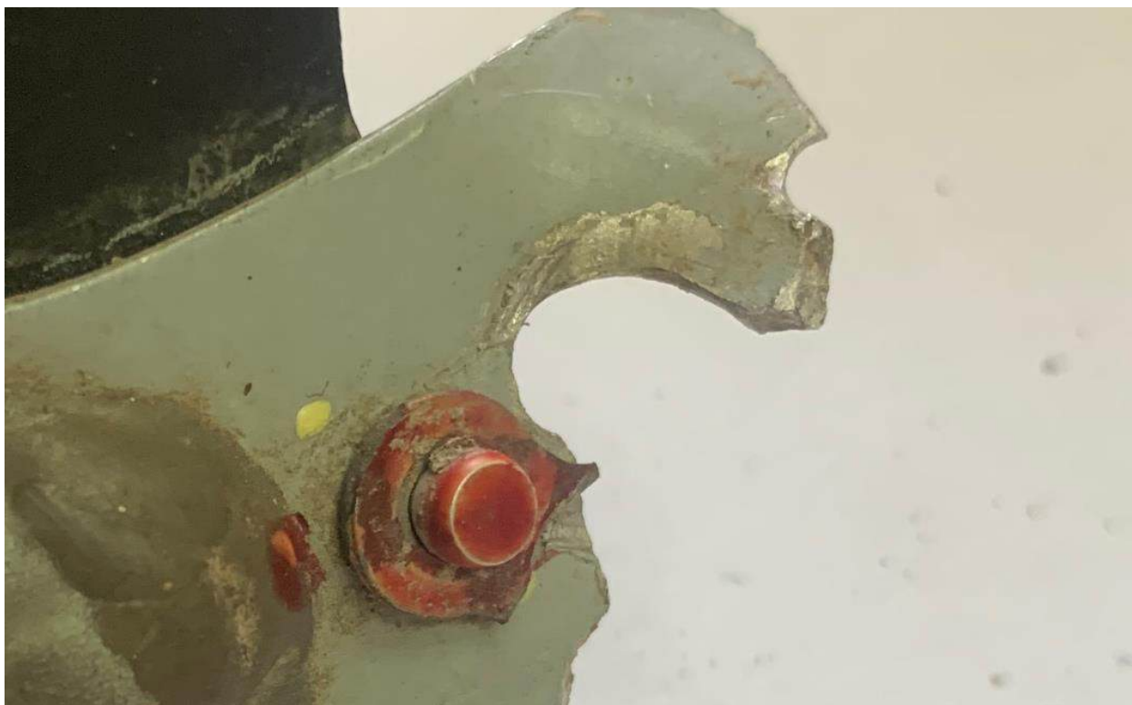
Рис. 110. Отверстие под гермогайку с фрагментом металлизации
