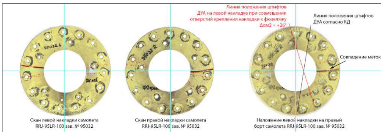
Рис. 104. Наложение левой накладки на правую (правый борт) ВС 95032 с совпадением меток
