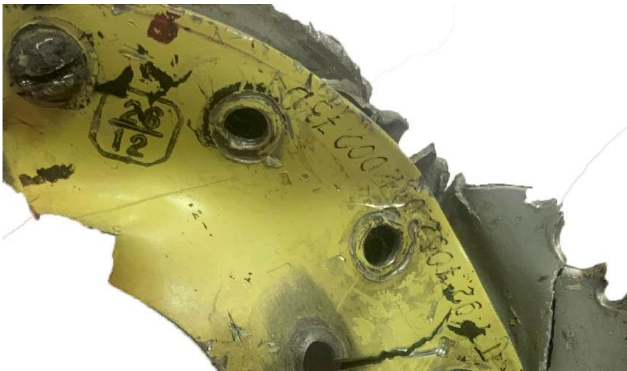
Рис. 116. Фрагмент накладки с чертежным номером и печатью ОТК
