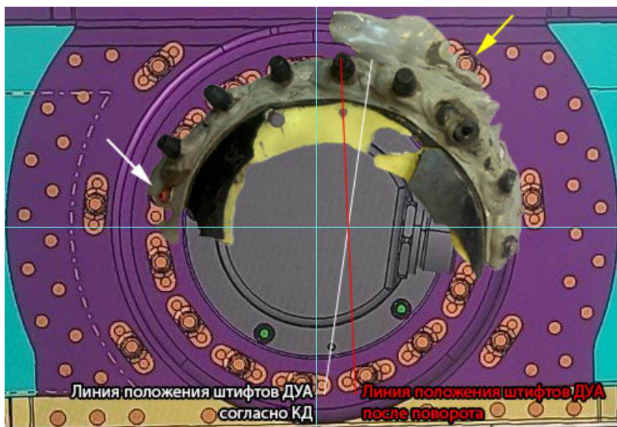
Рис. 121. Поворот оси ДУА при совмещении отверстий крепления крышки ДУА и гермогайки с заклепкой под металлизацию
