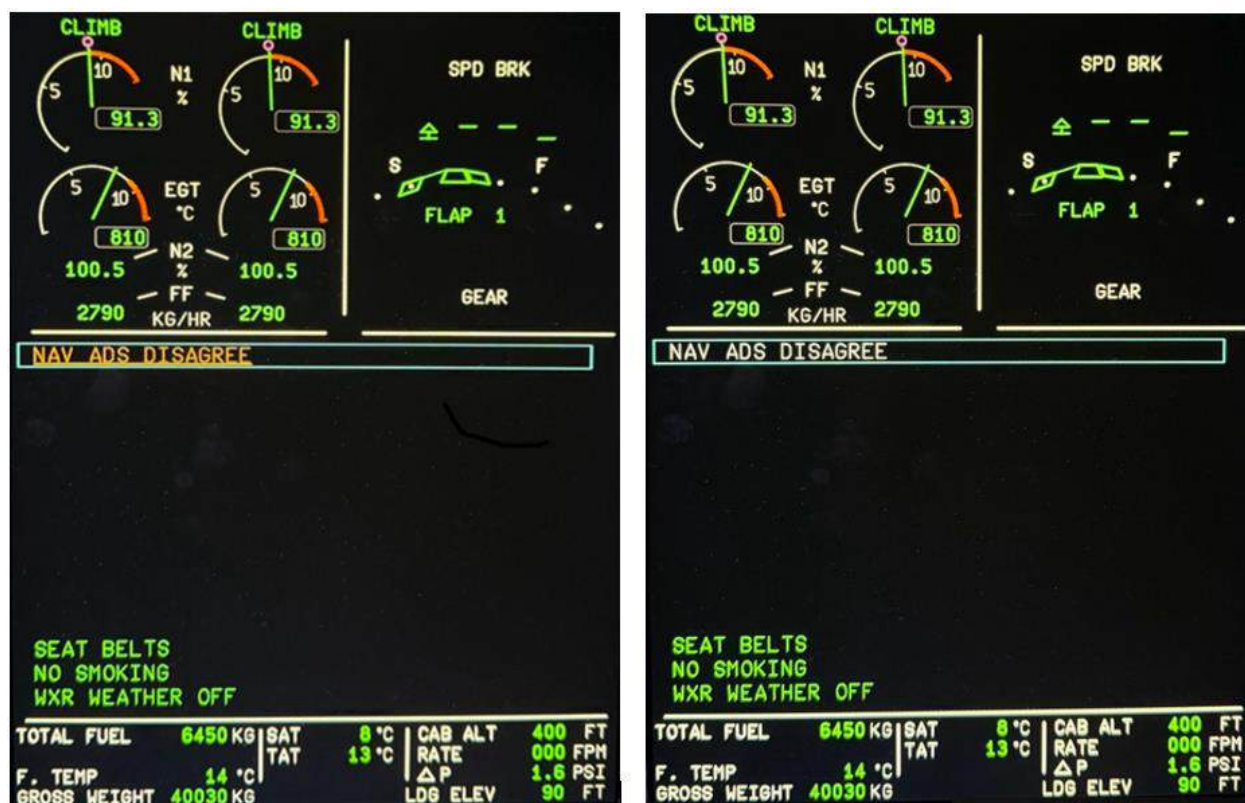
Рис. 141. Имитация индикации CAS-сообщения «NAV ADS DISAGREE» на EWD тренажера
