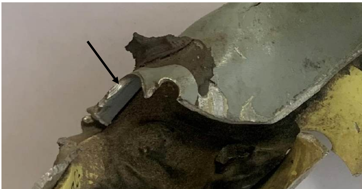
Рис. 111. Отверстие под гермогайку крепления крышки ДУА
