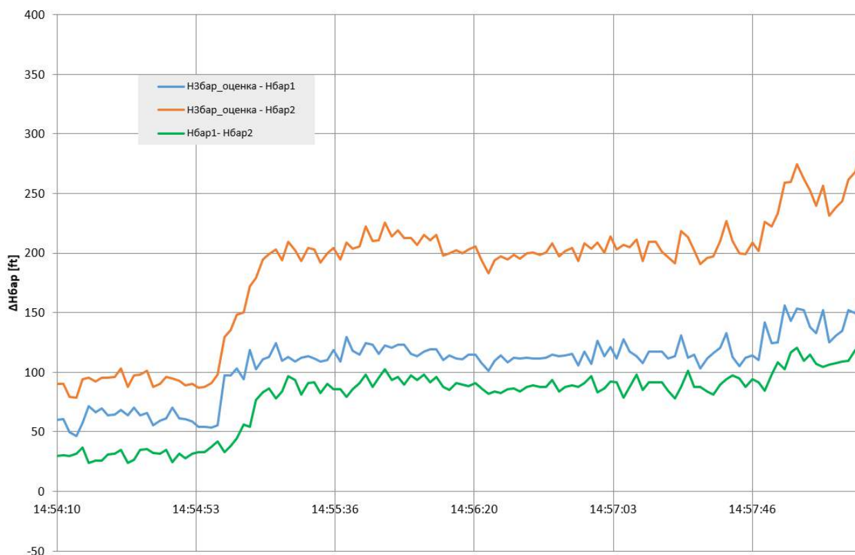
Рис. 63. Разность барометрических высот между ADS 1, 2, 3 (попарное сравнение)
